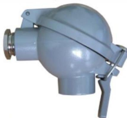
**ГКО-2-АЛ.** Головка коммутационная алюминиевая в сборе, с откидной крышкой, тип NAA2, керамическая колодка с двумя клемными винтами М4, IP54.
