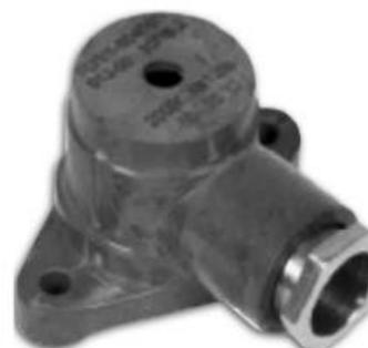
**ГП-2-ФУ.** Головка коммутационная, фенoplast (АГ-4В, ДСВ-2-0), угловой кабельный ввод, 2 клемных винта М3, температура эксплуатации до 100 °С, IP 54.
