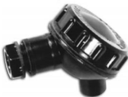
**Г-2-Ф.** Головка коммутационная, фенoplast (АГ-4В, ДСВ-2-0), температура эксплуатации до 200 °С, угловой кабельный ввод, 2 клемных винта М4, IP54.
