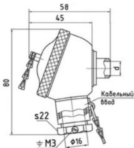
**Г-2-С, Г-3-С, Г-4-С, 2Г-4-С.** Головка коммутационная, сталь 12Х18Н10Т, электрохимическое полирование, керамическая колодка.
