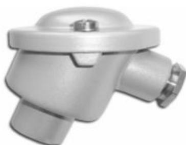
**ГК-2-АЛ.** Головка коммутационная, алюминиевая в сборе, тип ВА1, колодка керамическая с двумя клемными винтами М4, IP 54.
